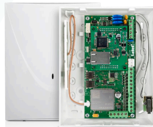
EL módulo GSM-X LTE con el módulo de ethernet GSM-X-ETH conectado.
