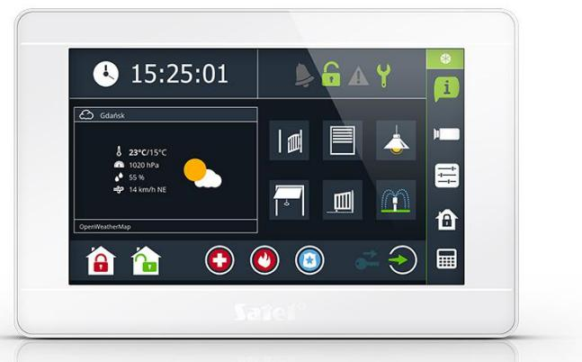
Работа виджета «Домофон» в клавиатуре INT-TSI, работающей совместно с дверными станциями, которые поддерживают протокол SIP, проверена на различных тестовых наборах. Лучшие результаты были получены при использовании следующих моделей дверных станций:
